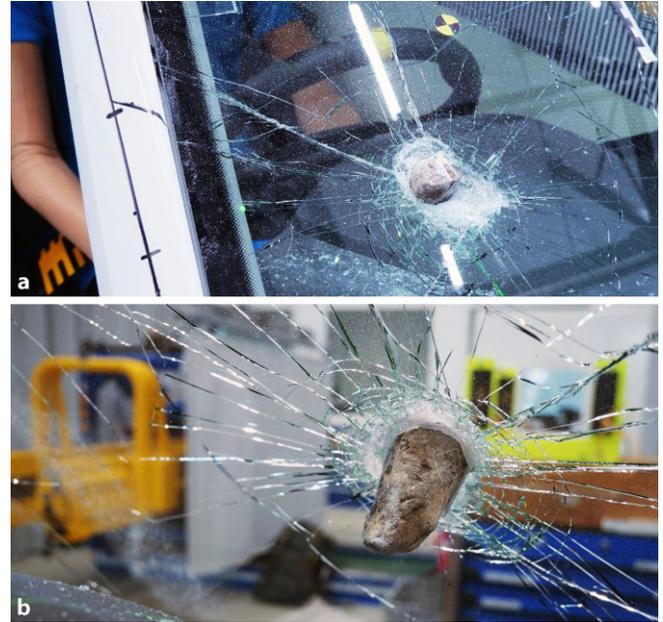
**Abb. 3** ▲ Mit 76 J auf eine Frontscheibe geschossener, 124 g schwerer Stein, der in der Frontscheibe stecken blieb (Versuch #4). a Außen-, b Innenperspektive
