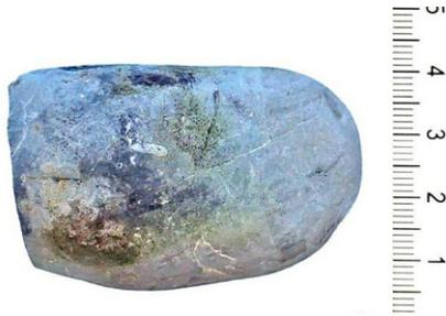
**Abb. 1** ▲ zeigt den für die Mehrzahl der Versuche verwendeten, natürlichen, aber für die Versuche einseitig abgeschliffenen, ca. 100 g schweren Stein. (Da der in **Abb. 1** dargestellte Stein initial zu schwer war, wurde ein Teil hiervon vor Versuchsbeginn abgetrennt, um einen etwa 100 g schweren Stein zu erhalten. Hierbei ergab sich auch dessen durchaus gewünschte Form mit abgerundeten Seiten, aber auch einer Kante)
