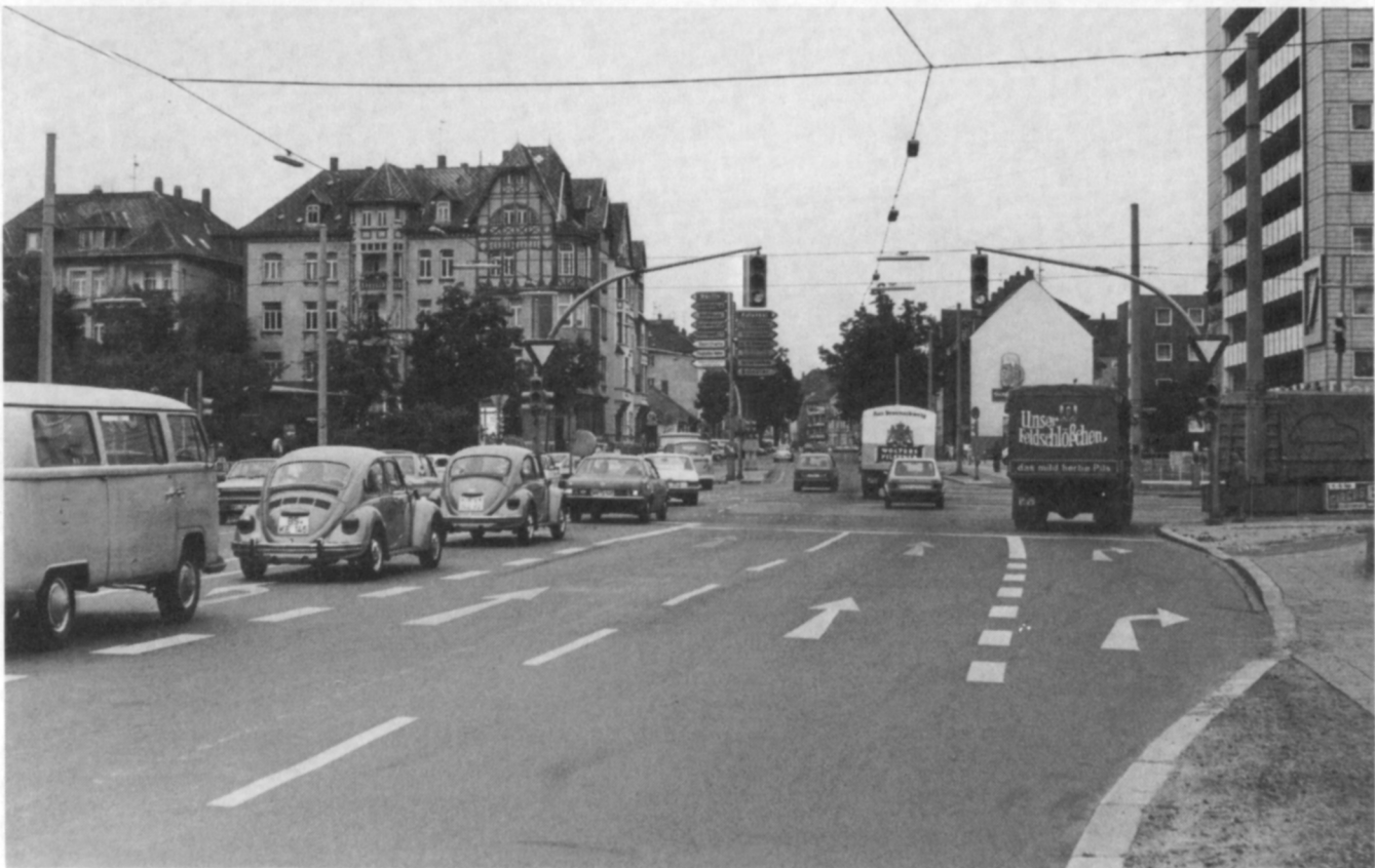
Bild 2: Zufahrt zu einem Knotenpunkt mit Lichtsignalanlage: Der Fahrstreifen für Linksabbieger ist sehr lang, oft bis vor den Beginn belegt, der Fahrstreifen für Rechtsabbieger ist sehr kurz, gelegentlich zu kurz
