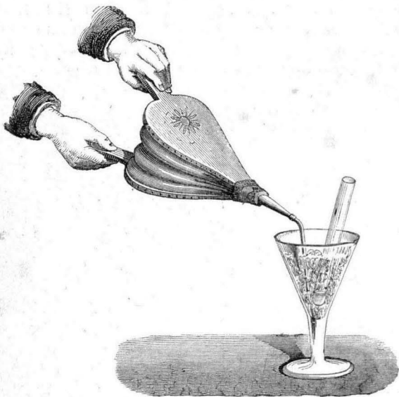
Fig. 126. Congelation de l'eau par l'évaporation de l'éther.
