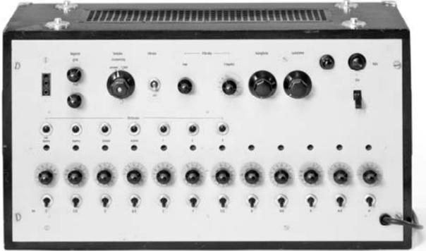
Abbildung 8: Der Sägezahngenerator
