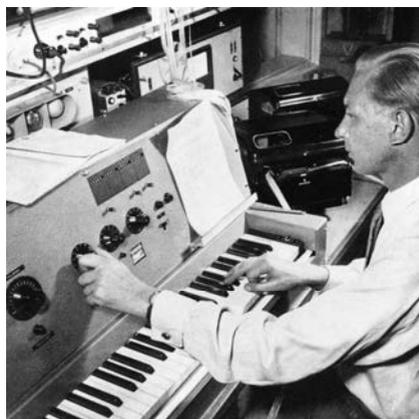
Abbildung 26: Codieren der Lochstreifen mit dem neu entwickelten Eingabegerät
