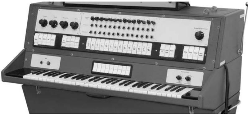
Abbildung 9: Das modifizierte Zungeninstrument, vollständig von Lochstreifen ansteuerbar einschließlich der im Aufsatz integrierten Filterbank und Dynamikregelung
