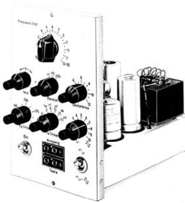
Abbildung 6: Ein einzelner Sinus-Generator (Einschub)
