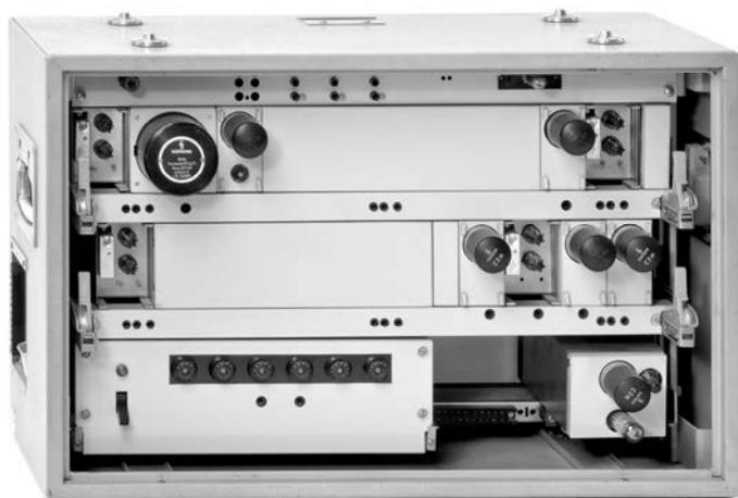
Abbildung 14: Der Frequenzumsetzer
