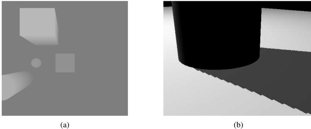
Abbildung 2.4: (a) Eine *Shadow Map* mit Tiefeninformationen aus Sicht der Lichtquelle, (b) *Aliasing* bei *Shadow Mapping* [8].
