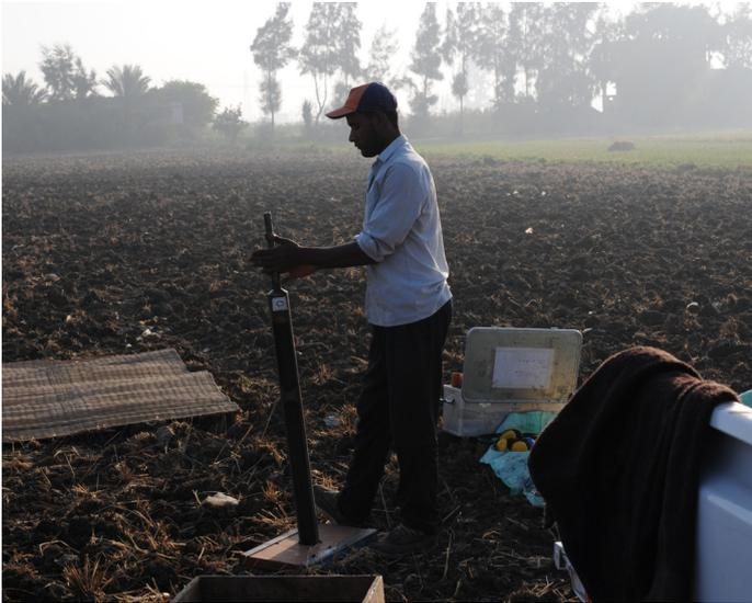
3 Herausziehen der Sonde mit dem ersten Meter einer Bohrung (Foto: R. Schiestl).
