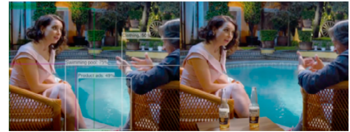
Abb. 1: Rendering virtueller Inhalte in ein Video basierend auf automatisierter Bildanalyse (mit freundlicher Genehmigung von Mirriad Inc., https://youtu.be/npW00T-W0WLE , 2019).
